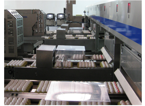
Tasnif makinesine kurulan CIJ yazıcılar
